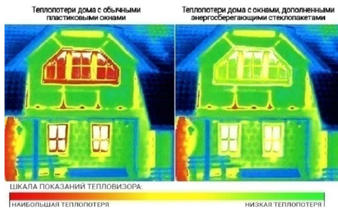
Рисунок 1 – Сравнение эффективности стандартных и энергосберегающих окон
