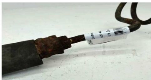
Рисунок 4 – Электрохимическая коррозия нагревательного элемента
