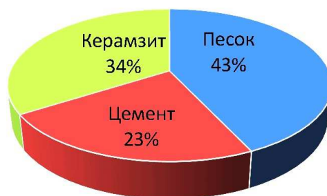
Рисунок 1 – Состав керамзитобетонных блоков
