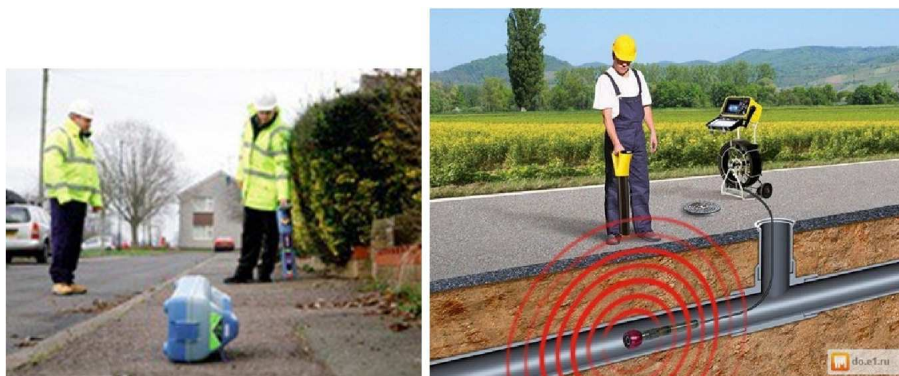
Рисунок 2 – Применение трассоискателя в геодезических изысканиях
