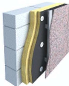
Рисунок 6 – Навесные вентилируемые фасады на кронштейнах, минеральная изоляция URSA GEO / TERRA [7]
