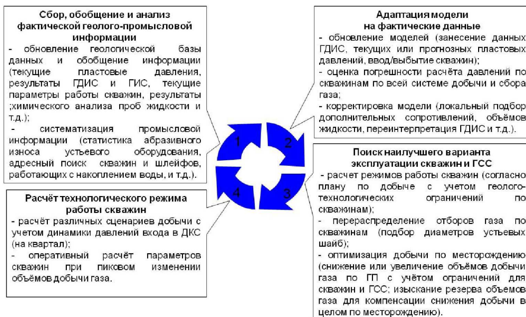
Рис. 4. Цикл обоснования режимов работы системы добычи и сбора газа
