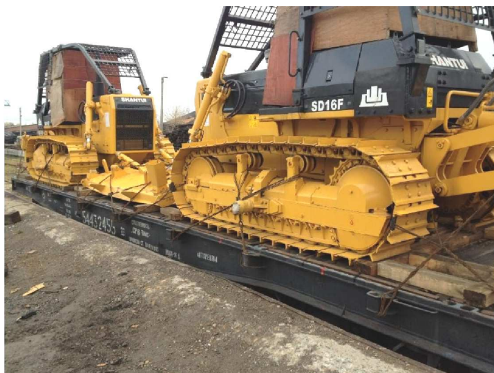
Рисунок 1 — Размещение и крепление грузов (гусеничной техники) при помощи проволочных растяжек и упорных блоков на открытом подвижном составе
