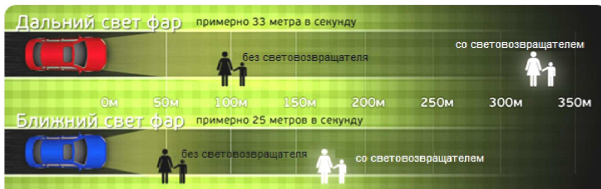
Рисунок 1 — Зависимость расстояния обнаружения пешехода от использования предметов со световозвращателями
