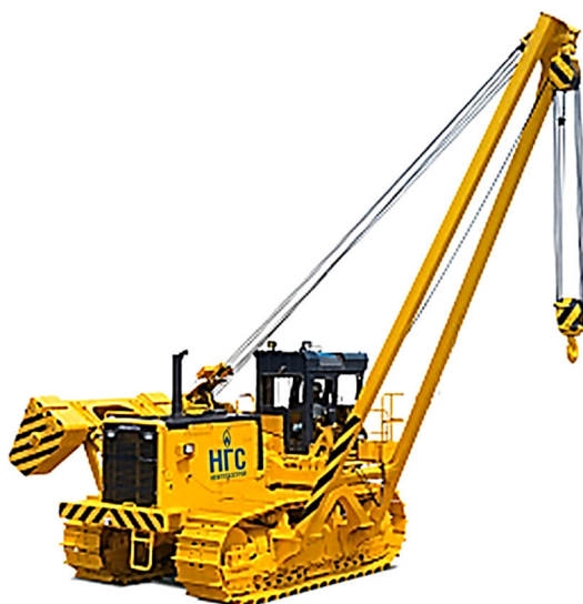
Рисунок 18 – Трубоукладчик KOMATSU D355C
