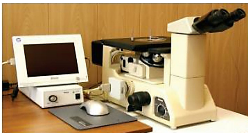
Рисунок 7 – Инвертированный металлургический микроскоп NIKON Epihot 200
