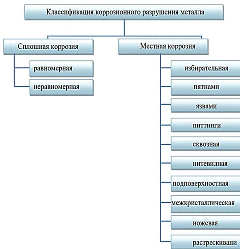
Рисунок 8 – Характер коррозионных разрушений
