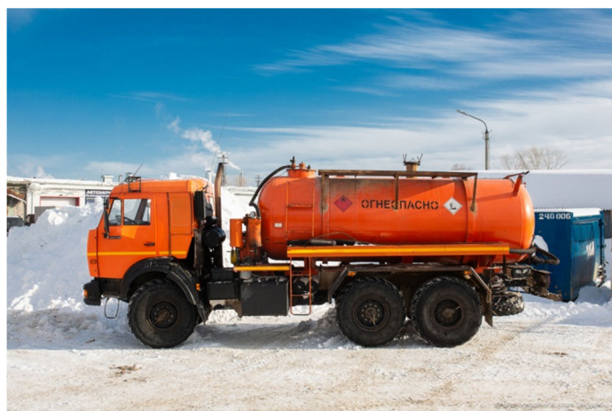
Рисунок 15 – Агрегат для сбора газового конденсата и нефтепродуктов АКН-10
