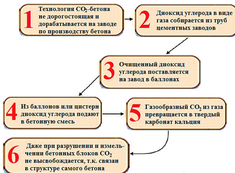
Рисунок 2 – Структурная схема этапов изготовления \text{CO}_2 -бетона
