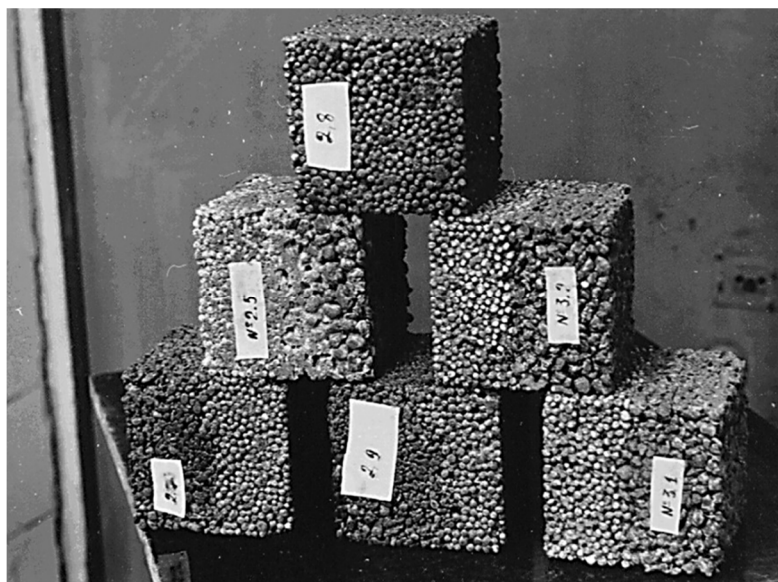
Рисунок 4 – Образцы для испытания на сцепление между слоями
