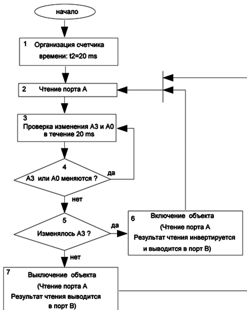
Рисунок 4 – Схема алгоритма управления приемником
