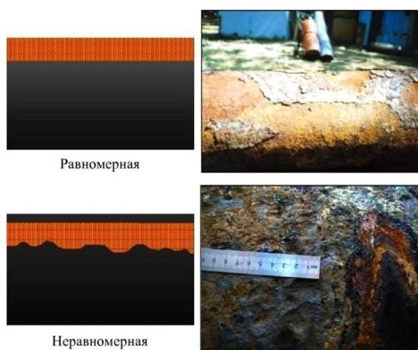
Рисунок 2 – Равномерная и неравномерная коррозия
