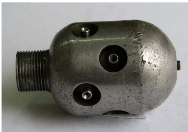
Рисунок 1 – Корпус с 2 рядами насадок (генераторов кавитации). Наружный диаметр 50 мм, внутренний диаметр насадок 0,95 мм, номинальное давление 40,0 МПа
