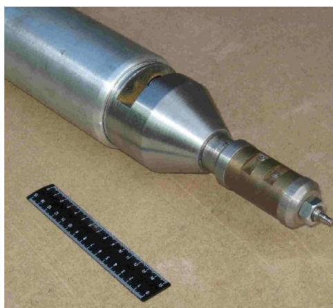
Рисунок 2 – Ротационный вибратор, совмещенный со струйным насосом. Диаметр корпуса 89 мм, номинальное давление 40,0 МПа
