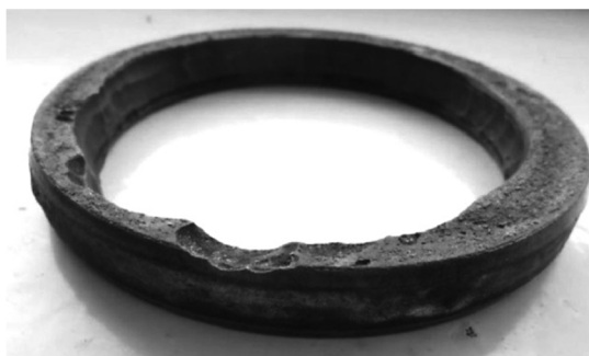
Рисунок 13 – Коррозионное разрушение уплотнительного кольца
