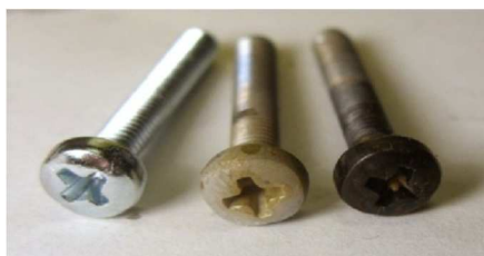
Рисунок 3 – Стальное изделие до и после этапов воронения металла
