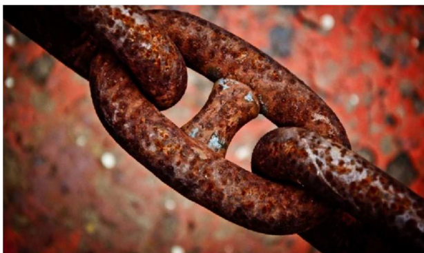
Рисунок 1 – Коррозия металлической цепи
