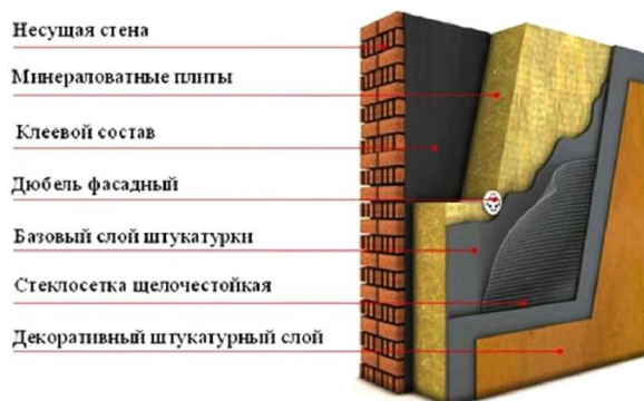
Рисунок 3 – Устройство штукатурного фасада
