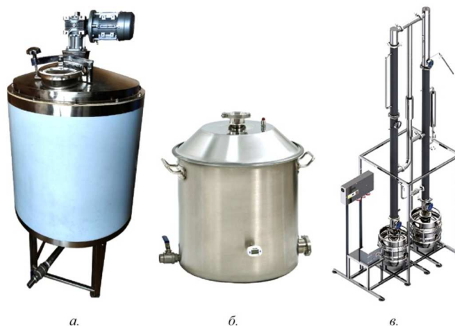
Рисунок 2 – Аппаратурное оформление процесса получения спирта из отходов производства бисквитных изделий в условиях малого предприятия
