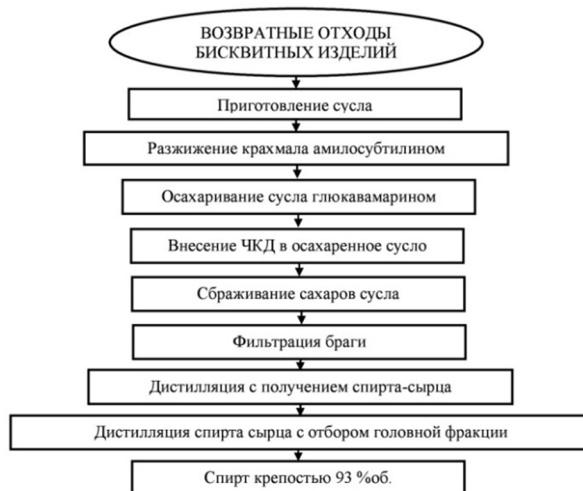
Рисунок 1 – Принципиальная технологическая схема утилизации возвратных отходов производств бисквитных изделий с получением этилового спирта
