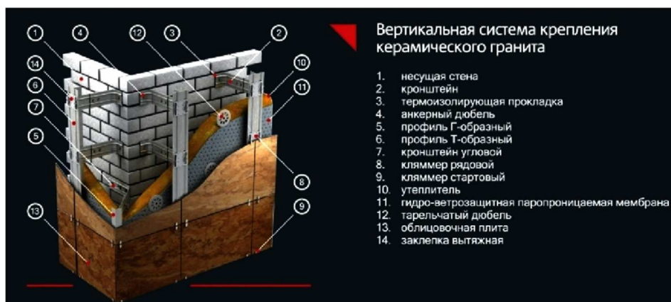
Рисунок 2 – Как устроен вентилируемый фасад
