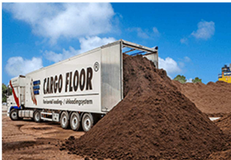
Рисунок 4 – Пример работы системы Cargo Floor на разгрузке сыпучих грузов из кузова автомобильного полуприцепа
