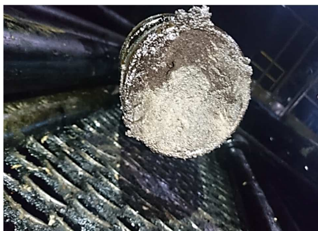
Рисунок 9 – Фотография с демонтажа ГНО на скважине № 2201Д-бис с засорённой НКТ песком
