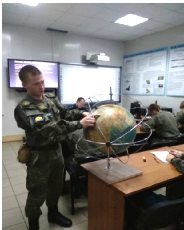
Рисунок 2 – Механический тренажёр для обучения курсантов определению местоположения самолёта в пространстве по известным навигационным параметрам. На втором плане – оборудование мультимедийного обеспечения образовательного процесса
