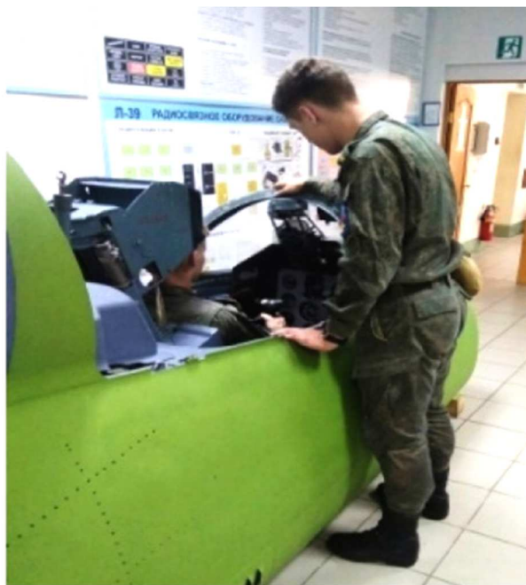
Рисунок 5 – Механический тренажёр для изучения оборудования передней кабины самолёта Л-39
