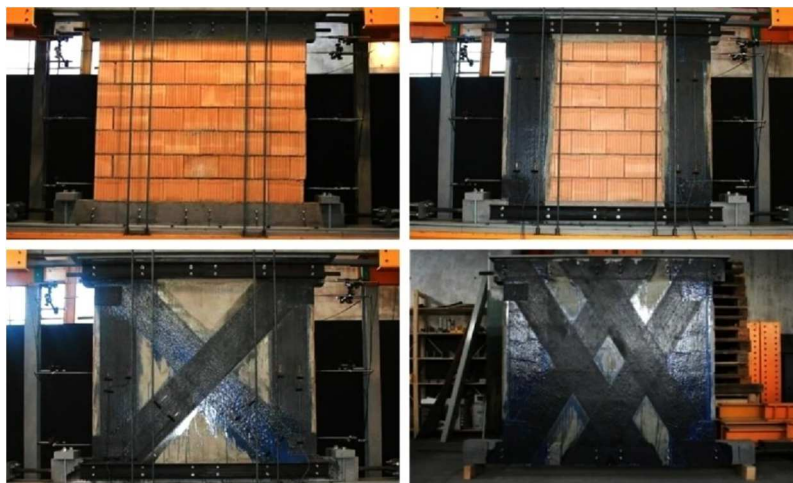
Рисунок 2 – Усиление кирпичной кладки композитным стекловолокном
