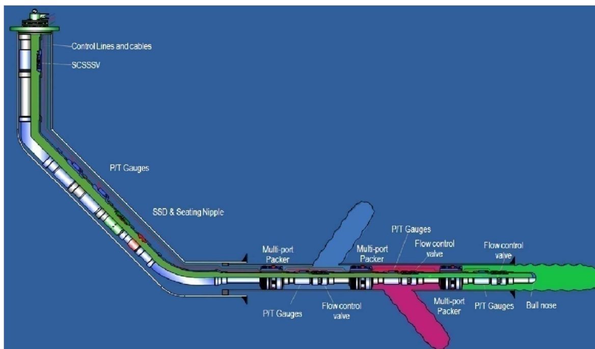
Рисунок 10 – Схема интеллектуального заканчивания скважин для многозабойной скважины карбонатного месторождения
