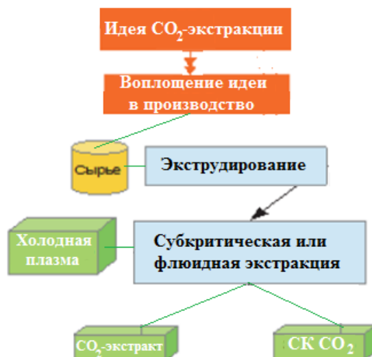
Рисунок 2 – Схема воплощения идеи CO 2 -экстракции до внедрения
