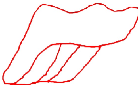
Рисунок 6 – Влияние газа на работу насоса, неполное заполнение цилиндра
