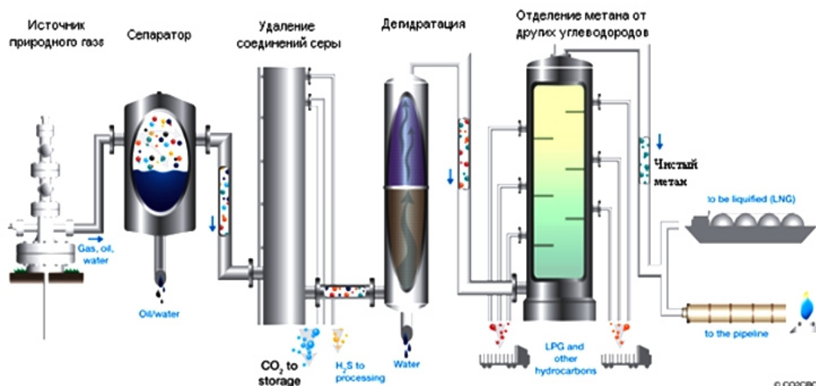
Рисунок 1 – Процесс сжижения природного газа (получение СПГ)
