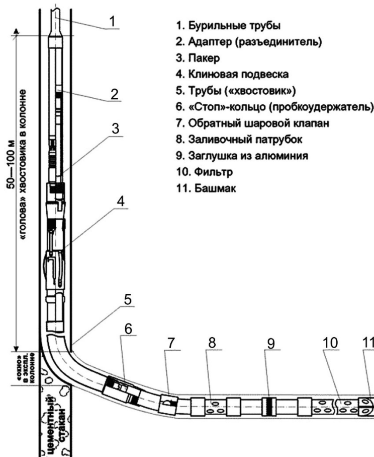
Рисунок 4 – Комплект инструмента и технологической оснастки для спуска, подвески и цементирования потайных обсадных колонн (хвостовиков) Ø 101,6 и 114 мм
