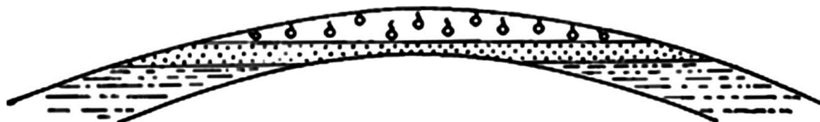
Рисунок 2 – Схема строения нефтегазовых залежей с подошвенной водой
