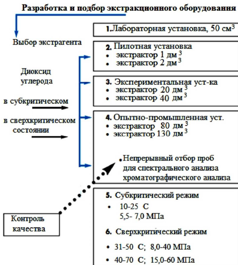
Рисунок 2 – Схема разработки и подбора экстракционного оборудования
