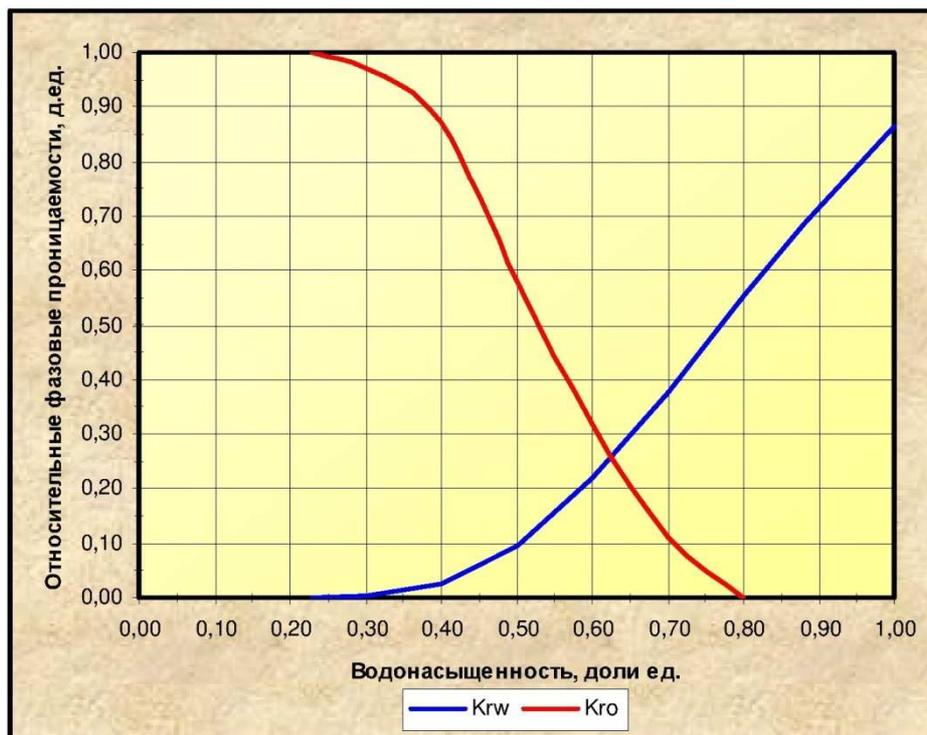
**Рисунок 9** – Характеристика модифицированных фазовых проницаемостей в системе «нефть – вода» пласта III<sub>0</sub> Чумаковского месторождения
