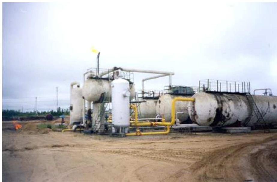
Рисунок 1 – Установка сепарации нефти месторождения Монги
