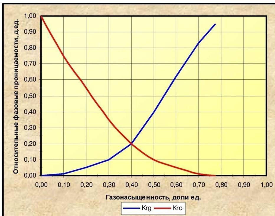
**Рисунок 10** – Характеристика модифицированных фазовых проницаемостей в системе «нефть – газ» пласта III<sub>0</sub> Чумаковского месторождения
