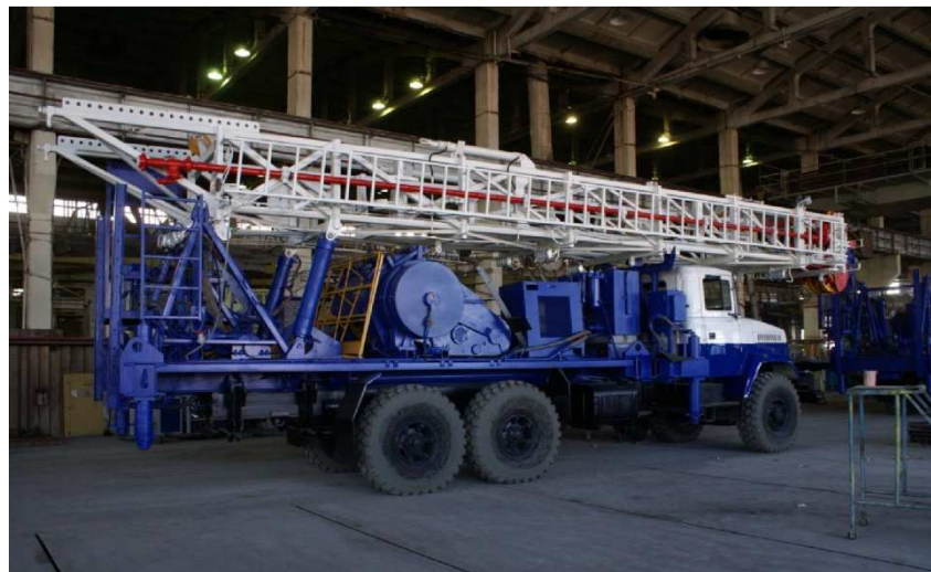
Рисунок 1 – Агрегат для освоения и ремонта скважин AP60
