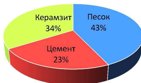
Рисунок 1 – Состав керамзитобетонных блоков
