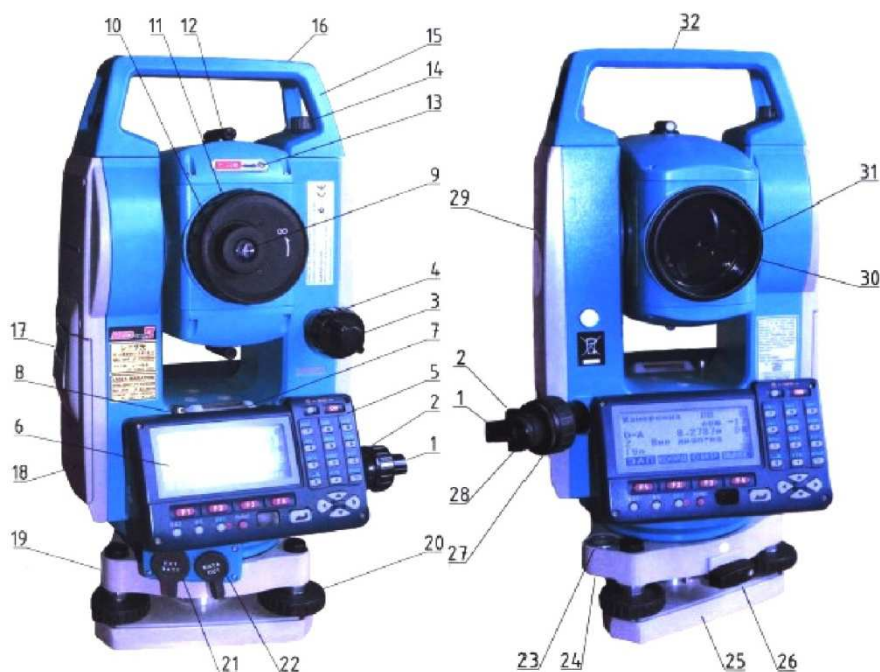
Рисунок 1 – Внешний вид электронного тахеометра
