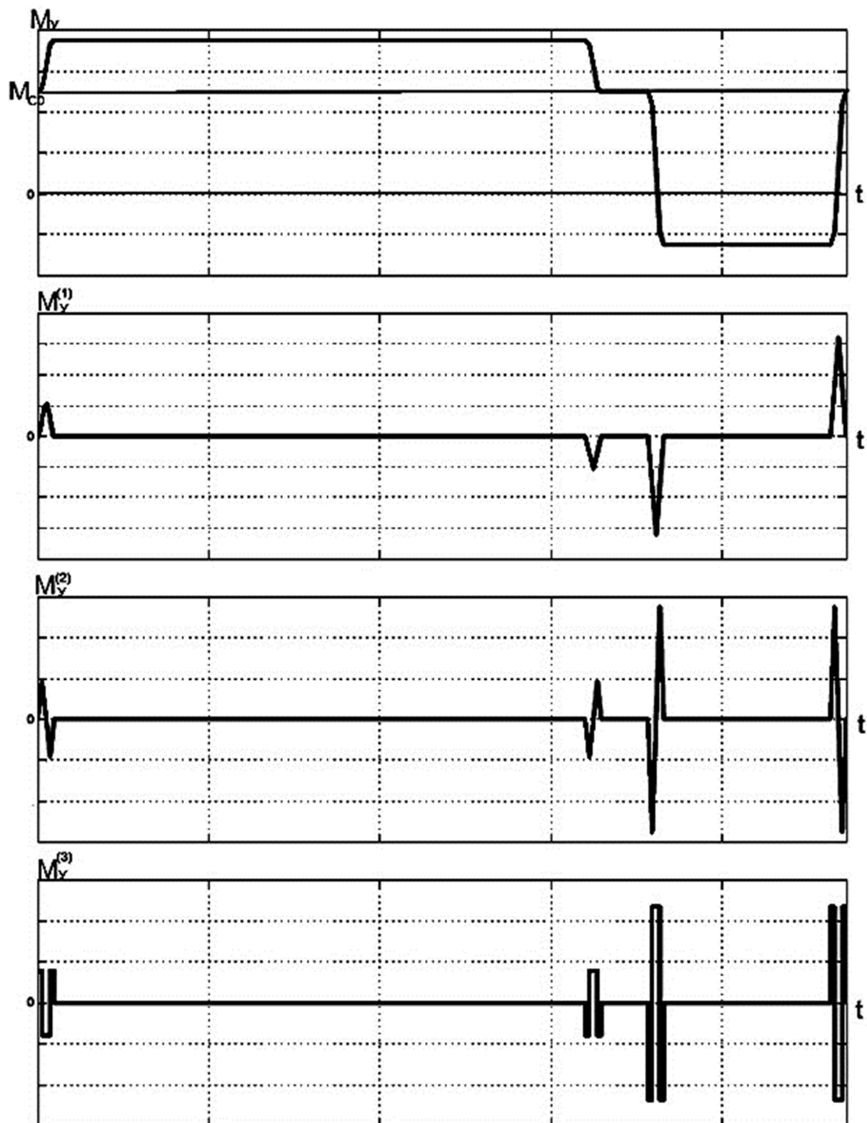
Рисунок 2 – Близкая к оптимальной по быстродействию диаграмма для больших перемещений исполнительного органа электропривода с упругим валопроводом (моменты упругости)
