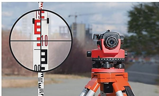
Рисунок 5 – Оптический нивелир
