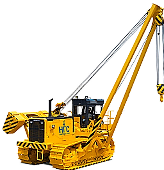
Рисунок 18 – Трубоукладчик KOMATSU D355C
