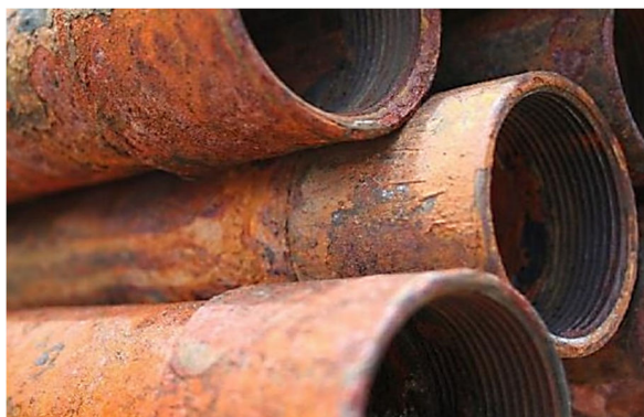
Рисунок 3 – Коррозия НКТ в нагнетательной скважине сточной воды произошла снаружи и изнутри
