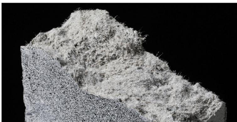
Рисунок 2 – Фибробетон с добавлением стекловолокна
