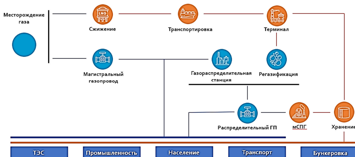
Рисунок 2 – Газовая производственная цепочка с учётом влияния малотоннажного сжиженного природного газа [3]
