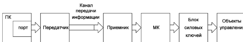
Рисунок 1 – Структурная схема системы дистанционного управления технологическим оборудованием
