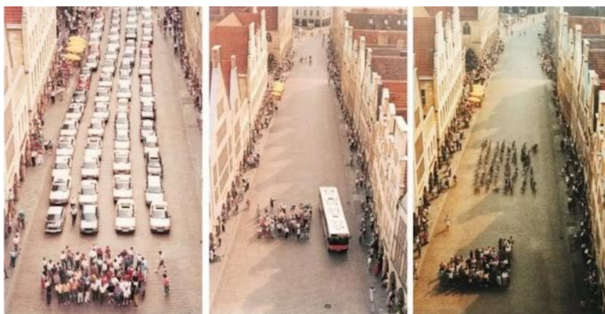
Рисунок 3 – Эксперимент по сравнению уличного пространства, занимаемого одной и той же группой людей, которые передвигаются на автомобилях, автобусе и на велосипедах
