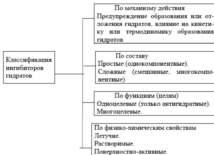
Рисунок 6 – Классификация ингибиторов гидратов
