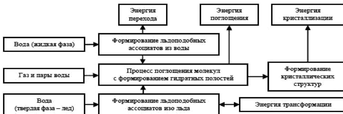
Рисунок 4 – Схема процесса гидратообразования из однокомпонентного газа
