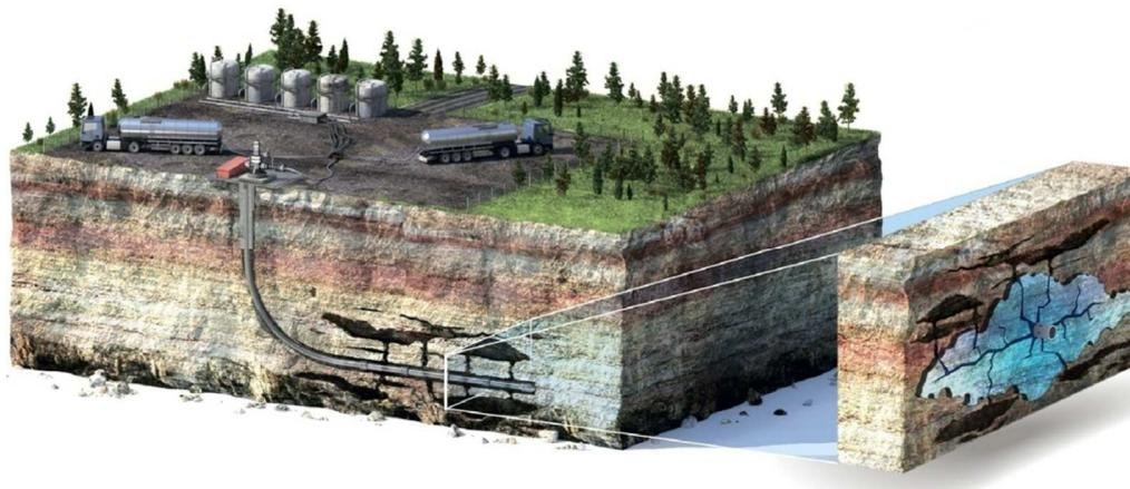
Рисунок 1 – Схематичное изображение гидравлического разрыва пласта
