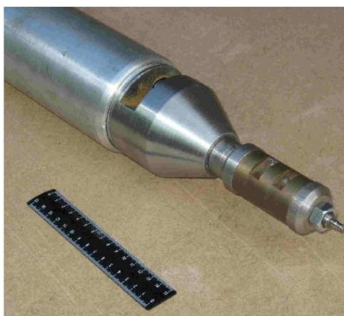
**Рисунок 2** – Ротационный вибратор, совмещенный со струйным насосом.
