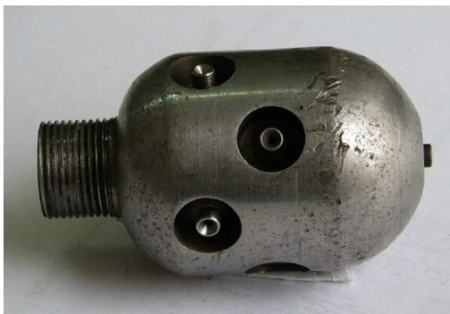
**Рисунок 1** – Корпус с 2 рядами насадок (генераторов кавитации).
