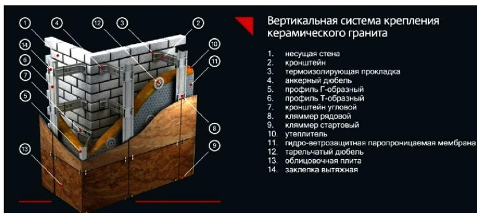
Рисунок 2 – Как устроен вентилируемый фасад
