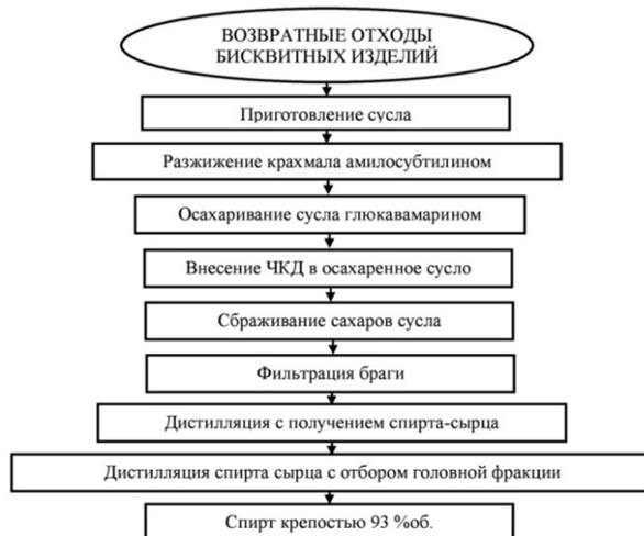
**Рисунок 1** – Принципиальная технологическая схема утилизации возвратных отходов производств бисквитных изделий с получением этилового спирта
