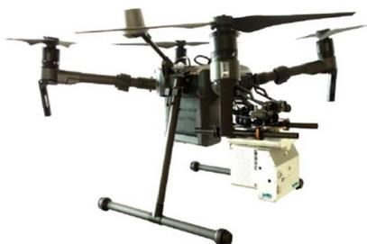
Рисунок 2 – БПЛА GreenValleyLiAIRV
