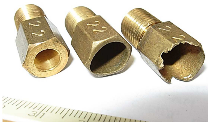
Рисунок 2 – Эрозия генераторов кавитации, d_0 = 2,2 мм: слева – новый, 2 и 3 – после 3 и 5 часов работы в водозаборной скважине ( \Delta P = 26 МПа, P_{кам} = 2,0 \div 3,5 МПа)
