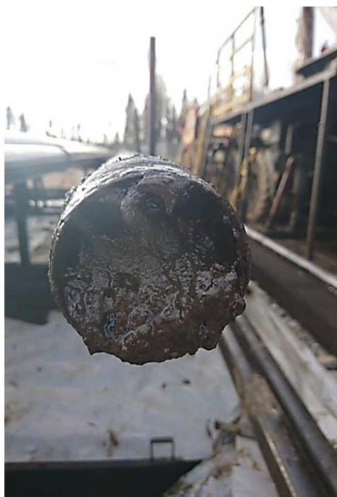
Рисунок 12 – Фотография с демонтажа ГНО на скважине № 2503Д с засоренной НКТ песком
