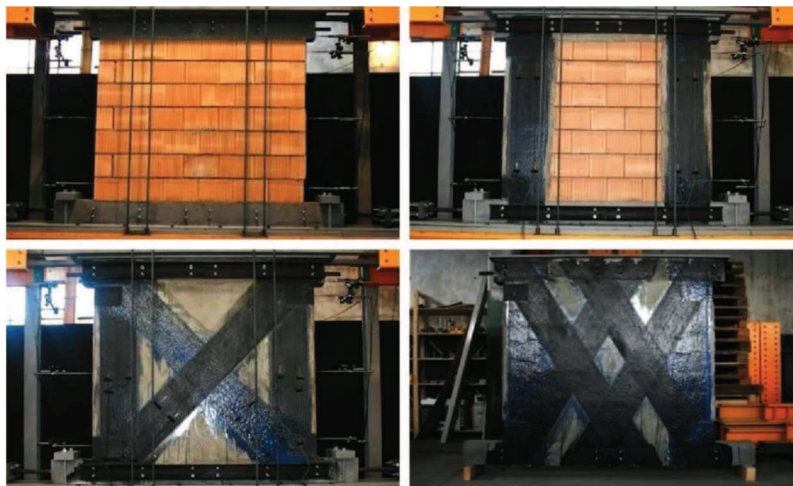
Рисунок 2 – Усиление кирпичной кладки композитным стекловолокном
