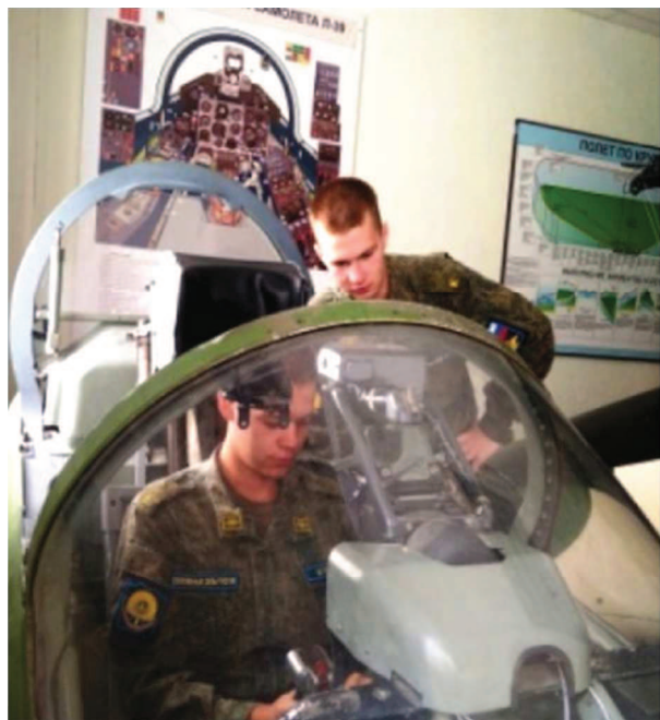
Рисунок 4 – Действующая («живая») кабина самолёта Л-39 для формирования практических навыков по подготовке к полёту, запуску, опробованию и останову двигателя
