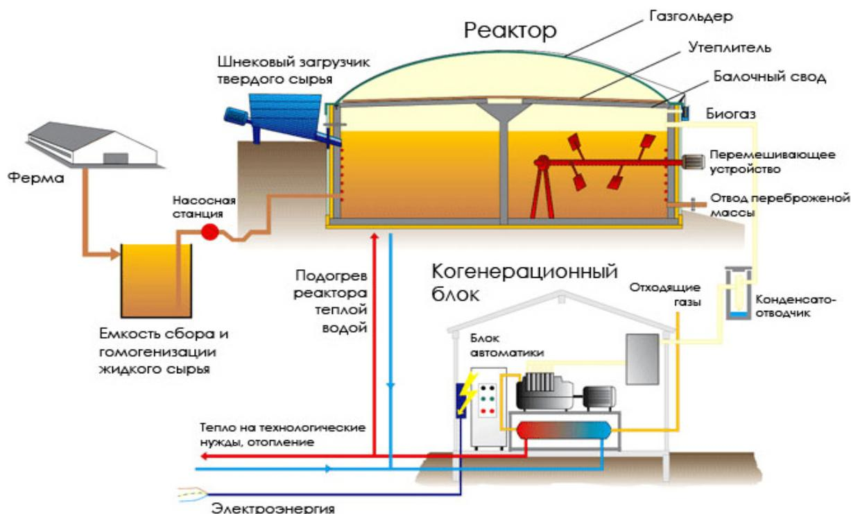
Рисунок 3 – Схема биогазовой установки
