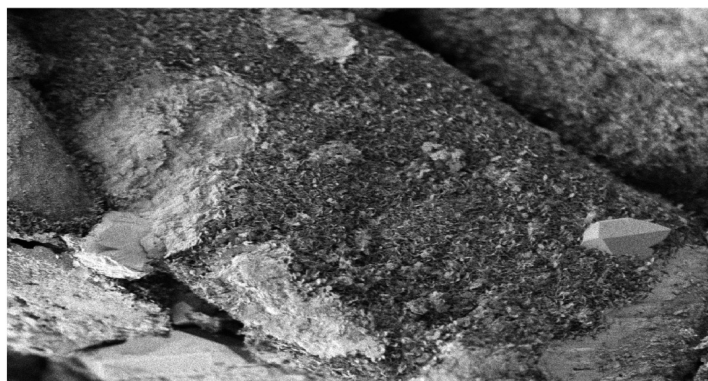
Рисунок 2 – Распределение глинистого цемента на поверхности зёрен породы в продуктивном песчанике пласта 1Nsr1 при \times 500 увеличении на сканирующем электронном микроскопе JSM-7500F
