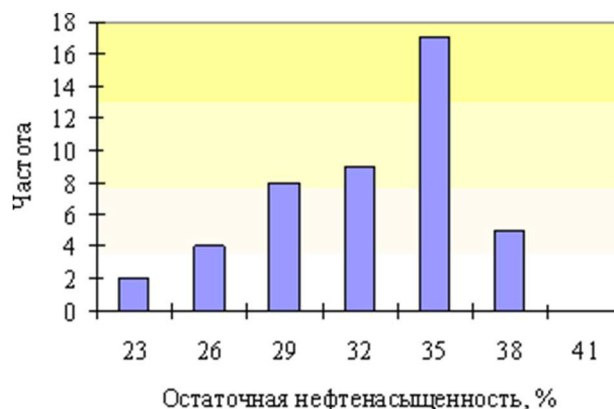
Рисунок 8 – Гистограмма распределения остаточной нефтенасыщенности пласта БП 10 2
