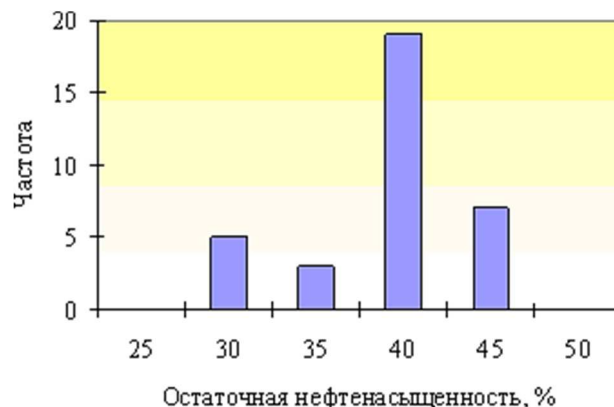
Рисунок 6 – Гистограмма распределения остаточной нефтенасыщенности пласта БП 8
