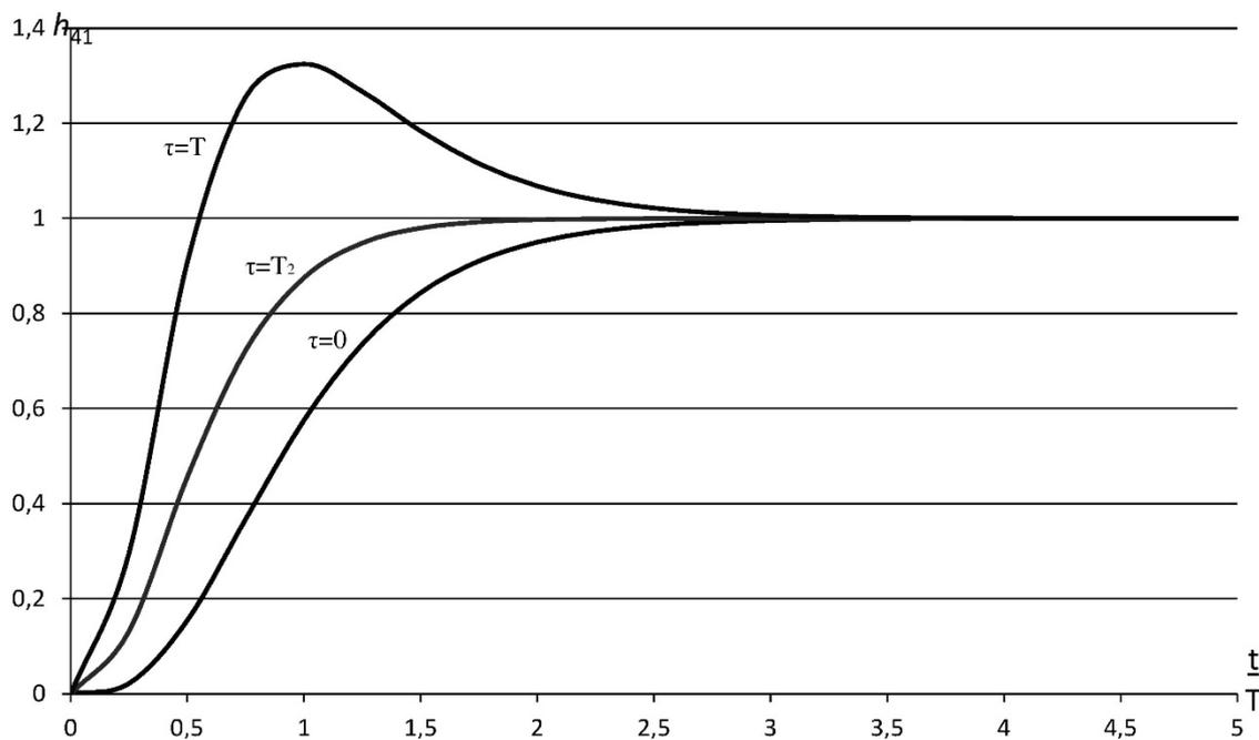
Рисунок 1 – Зависимость  $h_{41}$  от  $\frac{t}{T}$  при различных  $\tau$
