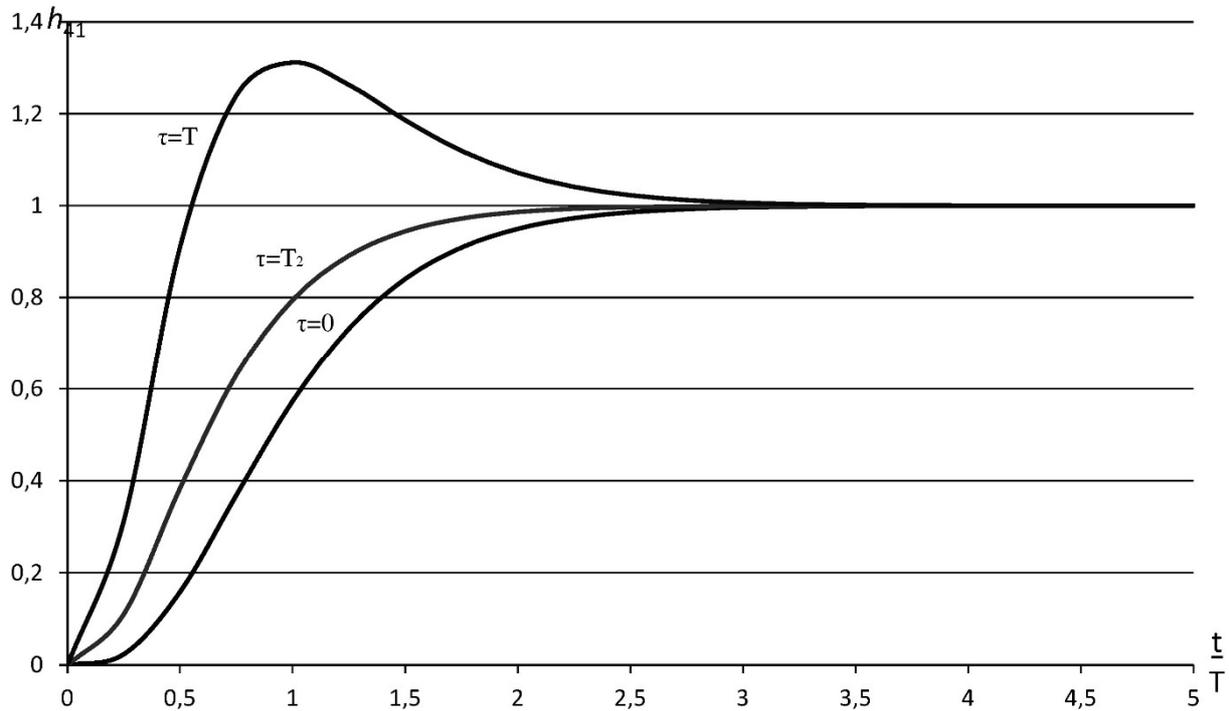
Рисунок 4 – Зависимость  $h_{41}$  от  $\frac{t}{T}$  при различных  $\tau$
