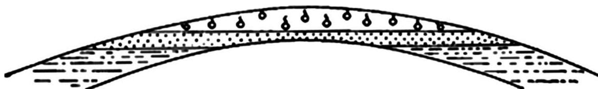
Рисунок 2 – Схема строения нефтегазовых залежей с подошвенной водой
