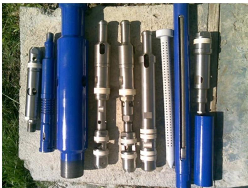
Рисунок 5 – Эжекторно-струйная установка ЕСП-2
