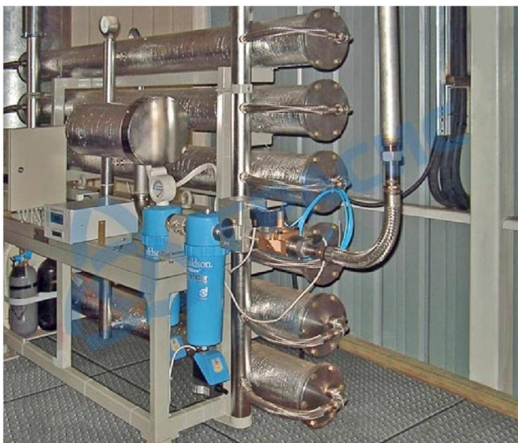
Рисунок 11 – Мембранная водородная установка
