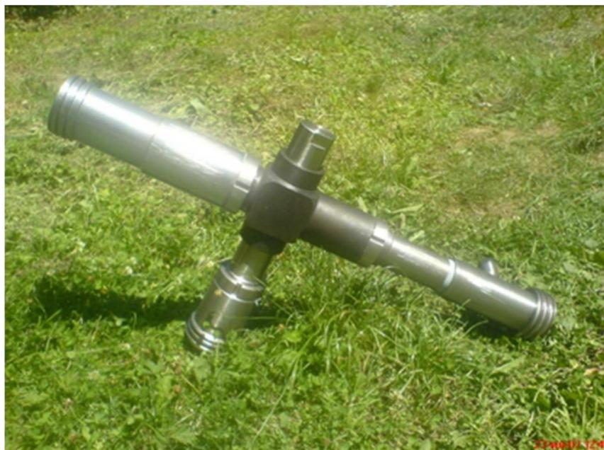
**Рисунок 8** – Эжектор жидкостно-газовый
