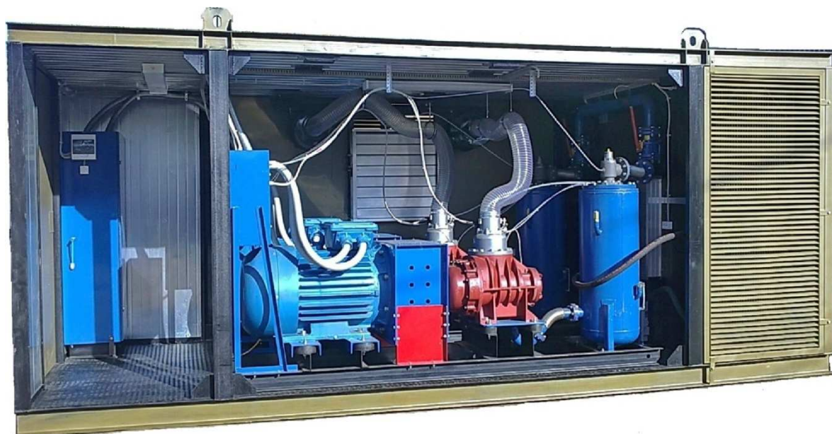
Рисунок 4 – Общий вид модульной компрессорной станции
