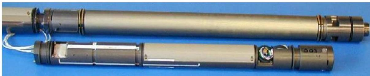
Рисунок 5 – Инклинометрический модуль в корпусе и отдельно
