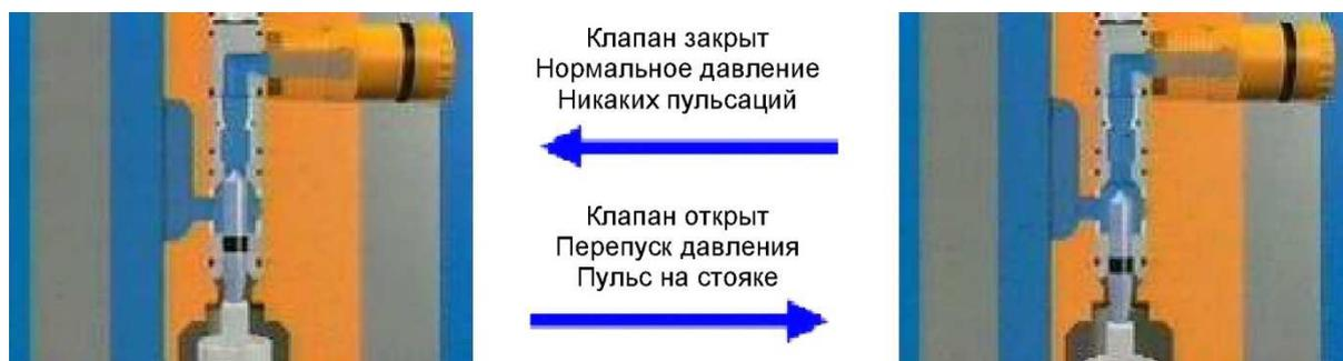
Рисунок 2 – Схема работы передатчика (пульсатора)
