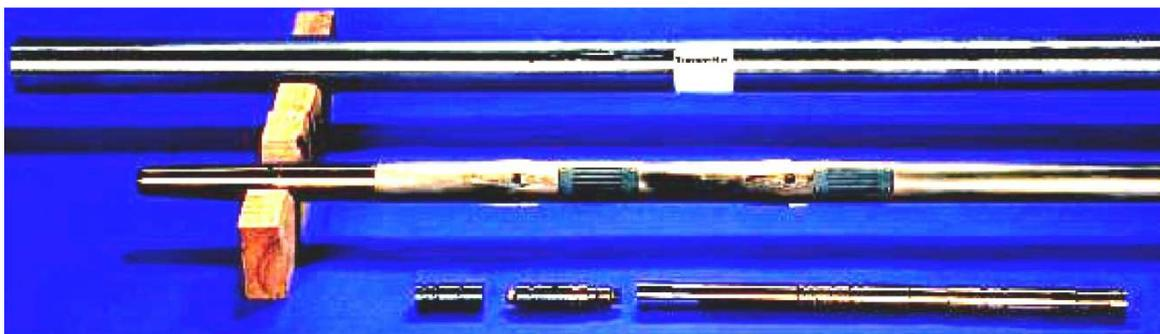
Рисунок 10 – Супертонкая телесистема
