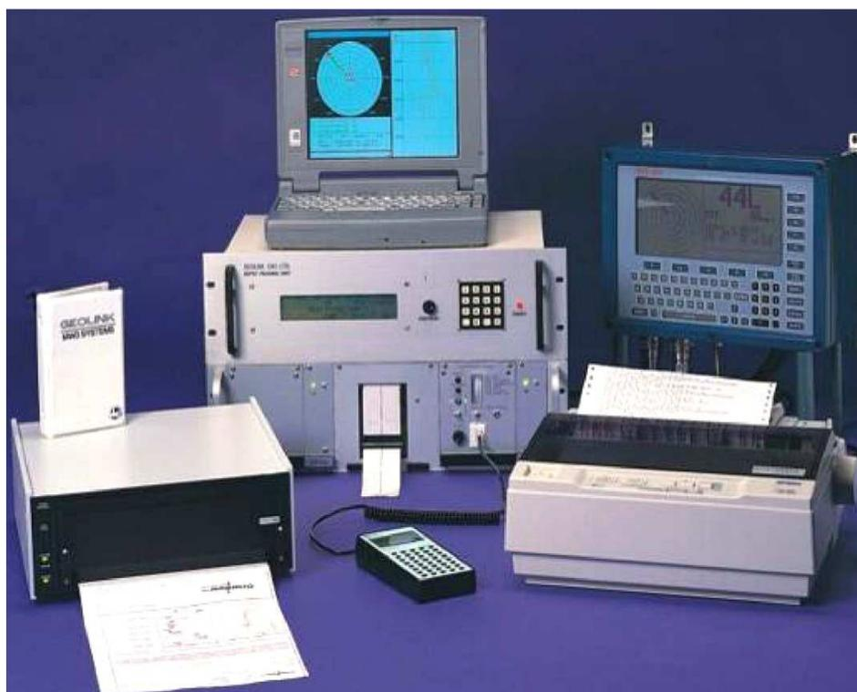
Рисунок 6 – Модули наземного оборудования телесистемы
