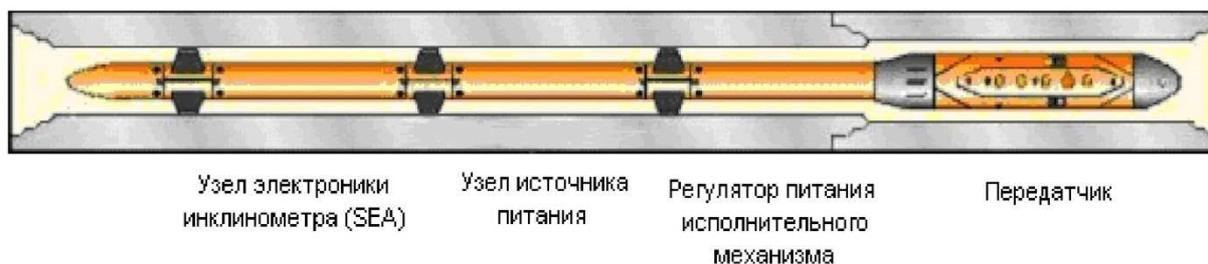
Рисунок 1 – Скважинный прибор в сборе
