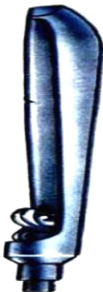
Рисунок 7 – Турбинный отклонитель с искривлённой буровой трубой
