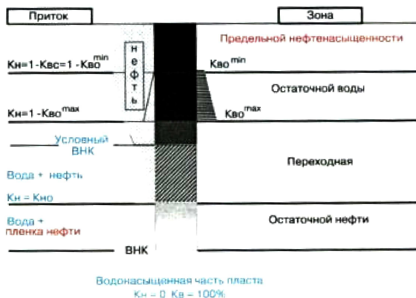
Рисунок 3 – Зоны нефтеводонасыщенности в однородном пласте большой мощности по В.К. Федорцову (1990)
